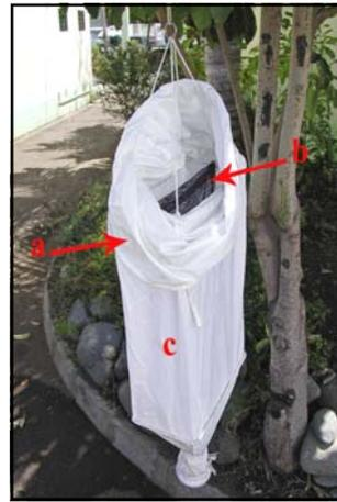
15b. Dispositif de Winkler; a. système de fermeture; b. filet contenant la litière à traiter; c. corps du Winkler (J. ROCHAT)
