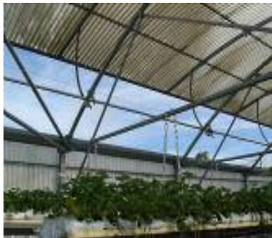
Pépinières P.F.O. : serre équipée d'ouvrants latéraux non munis d'insect-proof
