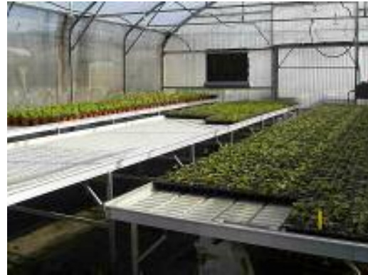
2004-2005, pépinières P.F.O. : serre d'élevage parois polycarbonate, couverte de plastique, aérée sur les côtés, et équipée de tablettes
