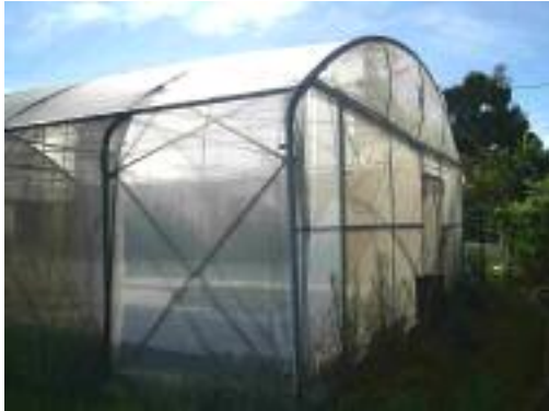
2004-2005, pépinières P.F.O. : serre d'élevage parois polycarbonate, couverte de plastique, aérée sur les côtés, et équipée de tablettes
